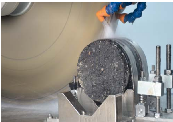
Резка керна (цилиндра) двумя дисками одновременно
