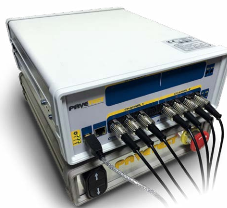
8-ми канальный CDAS с подключенными датчиками и блок управления HPS для гидравлической системы
